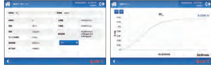
水分量を%・ppm・mgで表記 測定経過をグラフで確認できます
